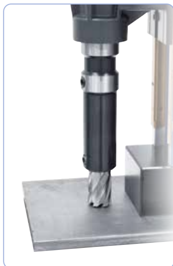
Kernbohren mit Verlängerungs- adapter
