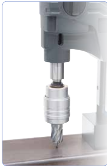
Kernbohren mit Schnellwechsellaufnahme
