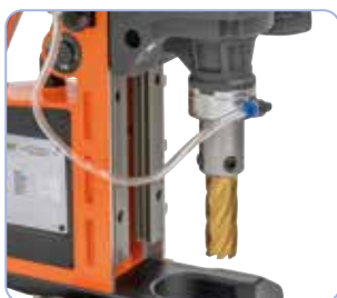
Automatische Innenschmierung, das Kühlmittel wird direkt an die Spitze des Kernbohrers geleitet
