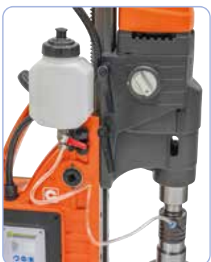
Automatische Innenschmierung, das Kühlmittel wird direkt an die Spitze des Kernbohrers geleitet.
