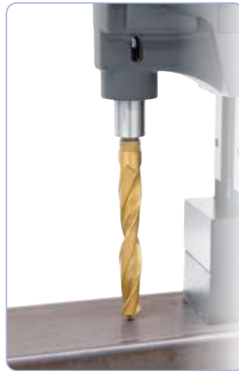
Bohren mit MK 2 - Spiralbohrer
