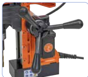
Mit Hebel-Mechanismus für automatischen Vorschub
