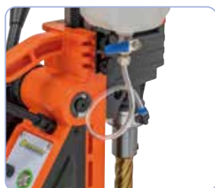
Automatische Innenschmierung, das Kühlmittel wird direkt an die Spitze des Kernbohrers geleitet
