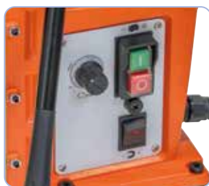
Genaueres Einstellen der Schnittgeschwindigkeit mittels Potentiometer.
