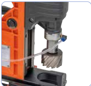
Automatische Innenschmierung, das Kühlmittel wird direkt an die Spitze des Kernbohrers geleitet
