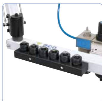
Platzsparende Aufbewahrung der Schnellwechselfutter direkt am Maschinenkörper (TM 12 P / TM 16 P).
