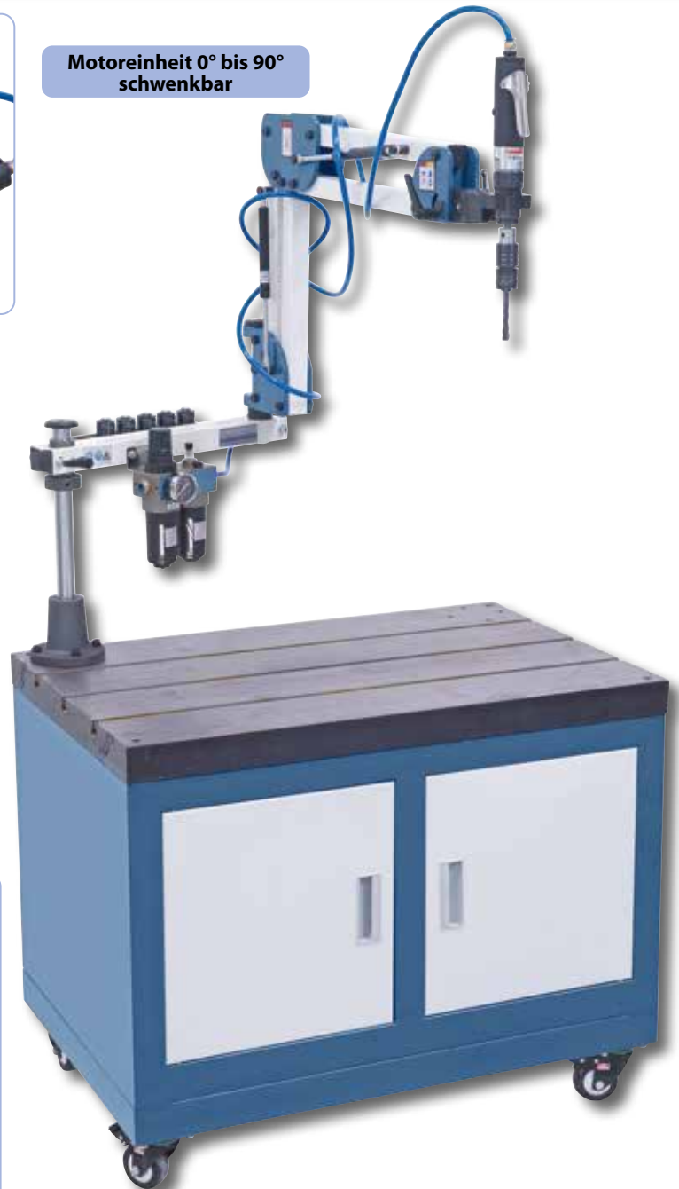
Inklusive Schwenkeinrichtung zum Horizontal- oder Schrägschneiden.
