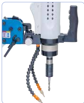
Serienmäßig mit Mikrosprühsystem und Ausblasvorrichtung.
