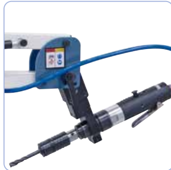
Inklusive Schwenkeinrichtung zum Horizontal- oder Schrägschneiden.
