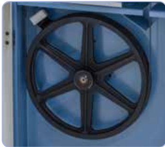
Das Antriebsrad mit Spezialgummibandage sorgt für einen ruhigen Lauf und erhöht die Lebensdauer des Sägebandes
