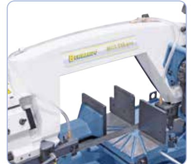
Hohe Schnittgenauigkeit durch den robusten Sägebügel aus Grauguss.
