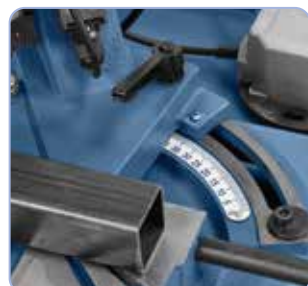
Schwenkbarer Sägebügel für Gehrungsschnitte bis 60°
