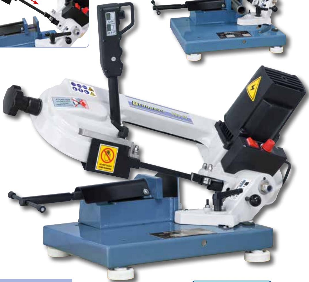
Sägebandführung kann auf die Materialbreite eingestellt werden.
