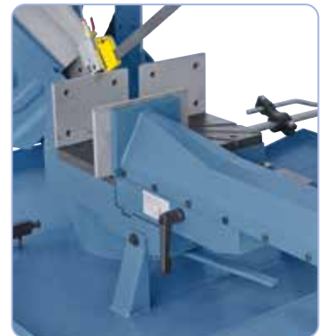
Sekundenschnelles Einstellen der gewünschten Öffnungsweite
