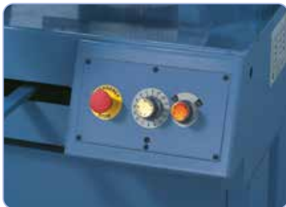
Komfortable Einstellung des Auflagedrucks mittels Regelventil.
