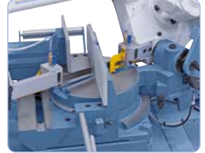
Der Sägeschlitz im Drehteller bewegt sich gleichzeitig mit dem Sägebügel.
