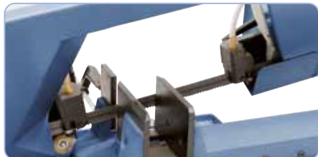
Kugelgelagerte Sägebandführung für präzise Schnitte
