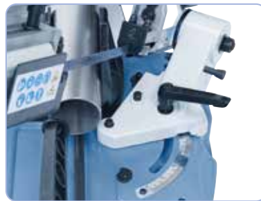
Verstellbarer Sägebügel zum Gehrungsschneiden
