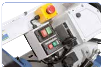
Übersichtliche Anordnung der Schaltelemente am Sägebügel.
