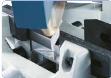
Schwenkbarer Getriebekopf [45° links / rechts], optimal für Gehrungsschnitte.
