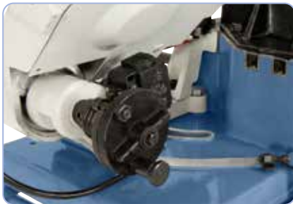
Auflagedruck des Sägebügels 3-fach einstellbar
