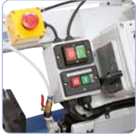
Zentrale Anordnung der Schaltelemente am Sägebügel
