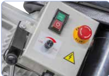
Variable Schnittgeschwindigkeit zur optimalen Anpassung an das jeweilige Werkstück, benutzerfreundliches Bedienpult.
