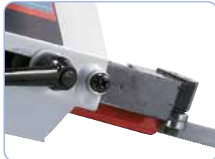
Kugelgelagerte Sägebandführung für optimale Schnittergebnisse.
