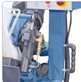
Großdimensionierter Hydraulikzylinder für stufenloses Absenken des Sägebügels
