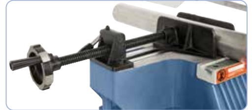
Serienmäßig mit patentiertem Schnellspannschraubstock ausgerüstet
