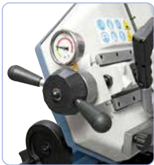
Das serienmäßige Manometer ermöglicht ein optimales Einstellen der Sägebandspannung.
