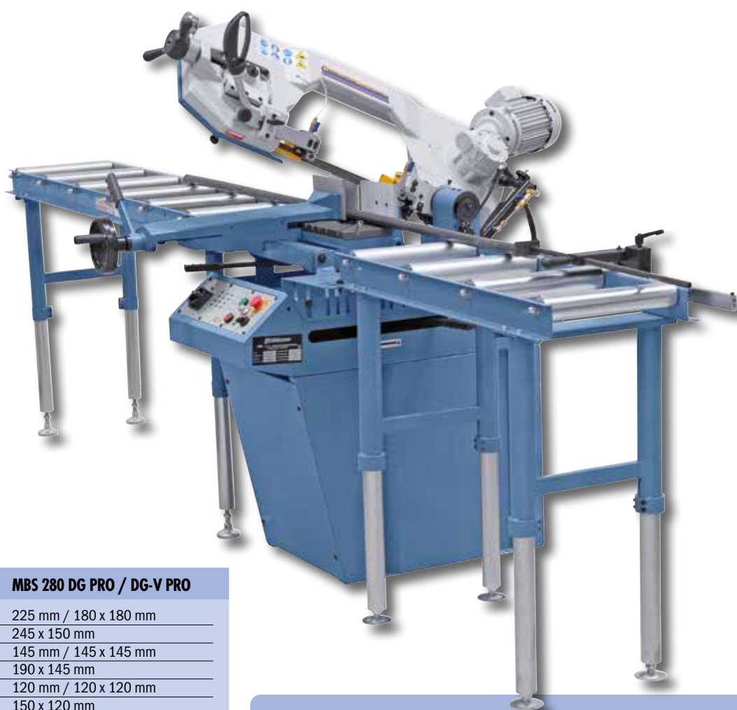
Schraubstock mit Schnellarretierung zum Doppelgehrungsschneiden verschiebbar
