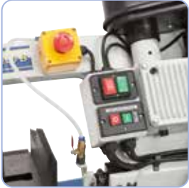
Zentrale Anordnung der Schaltelemente am Sägebügel
