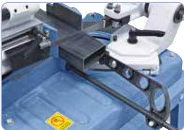
Inklusive Werkstückanschlag für rationelles Arbeiten, ideal für Serienschritte.
