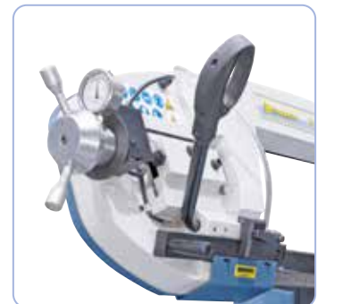
Ergonomischer Handgriff, Einstellen der Blattspannung mittels Handrad.
