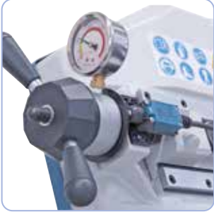
Kontrolle der Sägebandspannung mittels Manometer.
