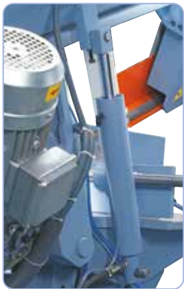
Stabiler Hydraulikzylinder zum feinfühligem Absenken des Sägebügels.
