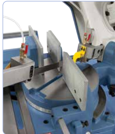
Der Sägeschlitz im Drehteller bewegt sich gleichzeitig mit dem Sägebügel.
