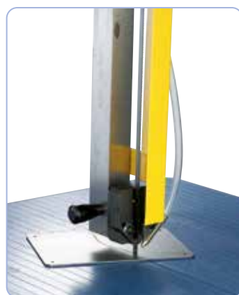
Kugelgelagerte Sägebandführung, einstellbar auf die jeweilige Werkstückhöhe.
