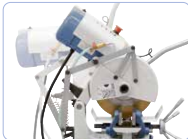
Schutzabdeckung öffnet automatisch beim Absenken des Getriebekopfes.
