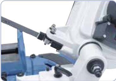
Kugelgelagerte Sägebandführung für optimale Schnittergebnisse.
