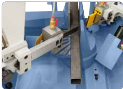
Schwenkbarer Sägebügel zum Gehrungsschneiden von 90° bis 60°
