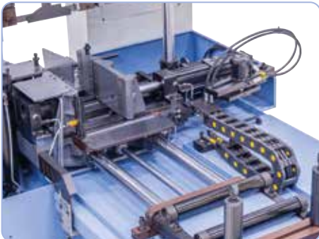
Materialvorschub über hydraulische Spanneinrichtung und präziser Rundführung
