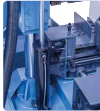
Stabiler Hydraulikzylinder zum feinfühligem Absenken des Sägebügels.
