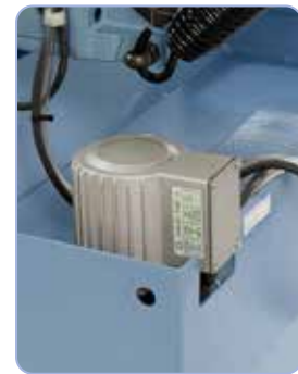
Leistungsstarke Kühlmittelpumpe im Lieferumfang enthalten
