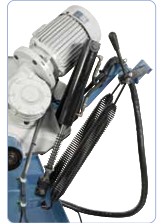
Zugfeder mit Einstellhebel zum Umstellen auf manuellen Betrieb.
