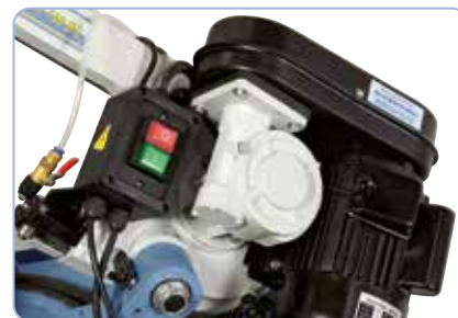
Mittels Keilriemen kann die Schnittgeschwindigkeit (23 / 33 / 52 m/min) gewechselt werden .
