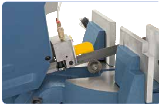
Kombinierte Rollen-Hartmetallführung verhindert schnellen Verschleiß des Sägebandes.
