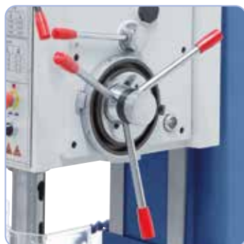
Sterngriff für manuelle Pinolenzustellung, Kupplungshebel für automatischen Vorschub.
