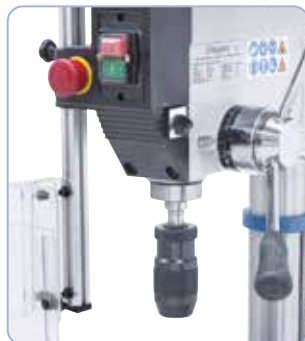
Serienmäßig mit einem Schnellspannbohrfutter 1 - 16 mm / B 16 ausgestattet
