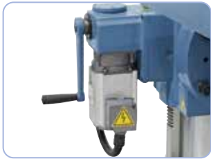
Komfortable, motorische Tischhöhenverstellung.
