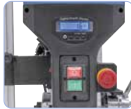
Digitale Bohrtiefenanzeige für komfortables Arbeiten.
