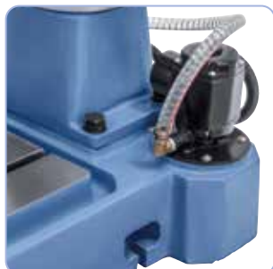
Präzise bearbeiteter Maschinenfuß, serienmäßig mit integrierter Kühlmittelpumpe (DMT 32 PFC).
