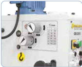
Einfache Bedienung der Schaltelemente für den Drehzahlwechsel.
