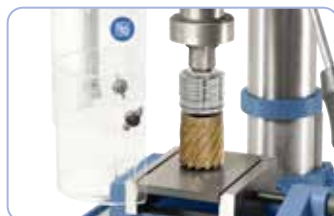
Optionale Schnellwechsellaufnahme zur Verwendung von Kernbohrer
