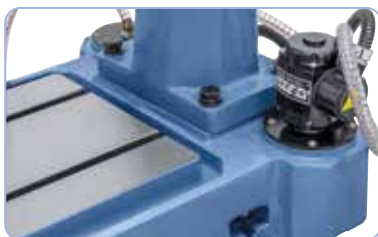
Präzise bearbeiteter Maschinenfuß, serienmäßig mit integrierter Kühlmittelpumpe
