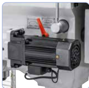
Stufenlos einstellbarer Pinolenvorschub mit separatem Antriebsmotor.
