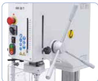
Leichtgängige Pinolenzustellung über ergonomisch angeordnete Handgriffe
