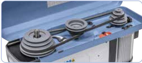
Hochwertige Keilriemen sorgen für eine optimale Kraftübertragung
