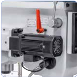
Stufenlos einstellbarer Pinolenvorschub mit separatem Antriebsmotor.
