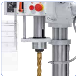
Stufenlos einstellbarer Pinolenvorschub mit separatem Antriebsmotor.
