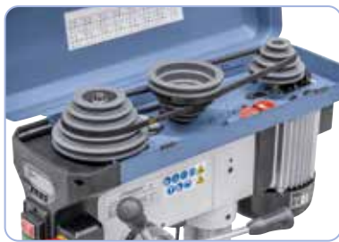
Hohe Laufruhe durch gewuchtete Antriebsscheiben.
