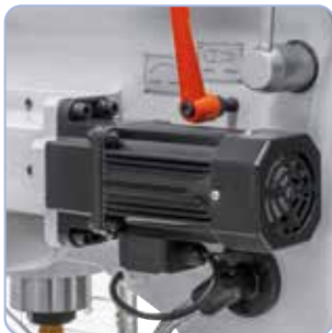
Stufenlos einstellbarer Pinolenvorschub mit separatem Antriebsmotor.
