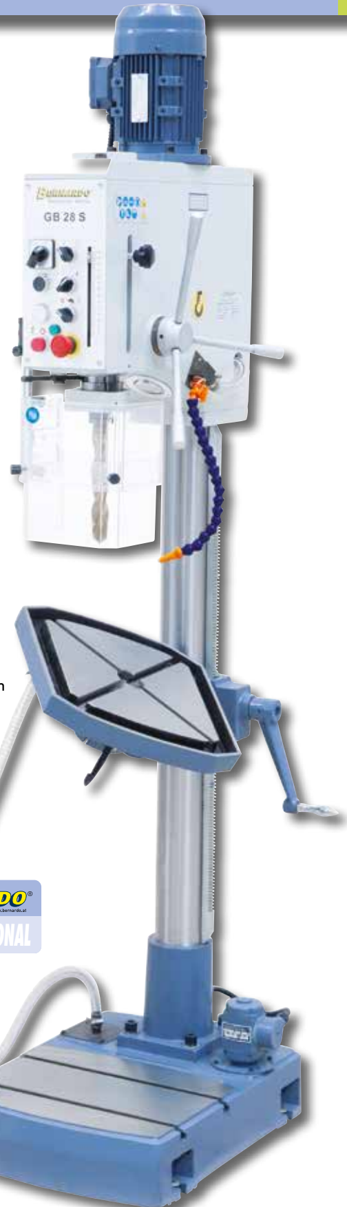
Der Arbeitstisch ist um 360° drehbar, ideal zum Koordinatenbohren.
