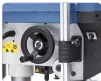
Seitlich positioniertes Handrad zur Einstellung der gewünschten Drehzahl
