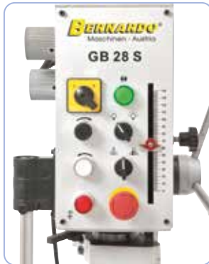
Übersichtlich angeordnete Schaltelemente, serienmäßig mit Gewindeschneideinrichtung.
