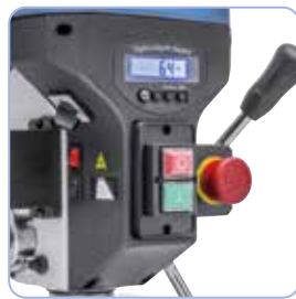
Digitale Bohrtiefenanzeige für komfortables Arbeiten.
