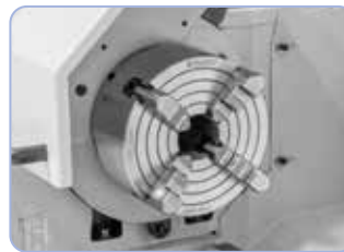
Planscheibe 200 mm (Standard) ideal zum Aufspannen von asymmetrischen Werkstücken.
