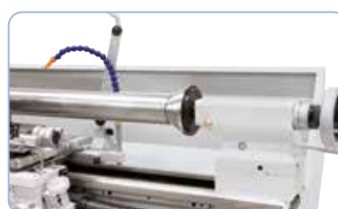
Zentrierkegel diam. 125 mm, ideal zum Spannen von Rohren und Hohlkörpern (Option).
