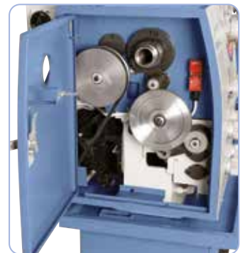
Lieferumfang komplett mit Wechselräder zum Gewindeschneiden
