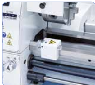
Modell 700 Top serienmäßig mit Rutschkupplung und Mikrometerlängsanschlag ausgestattet
