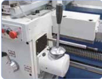
Serienmäßig mit Eilgang zur Reduzierung der Nebenzeiten.
