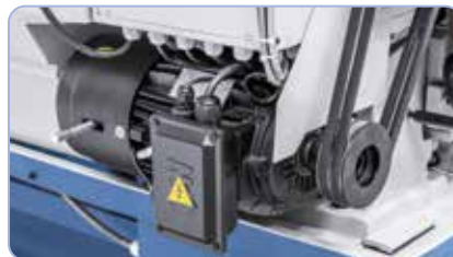
Leistungsstarker Antriebsmotor mit Magnetbremse nach CE-Norm.
