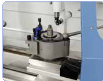
Der Schnellwechselstahlhalter ermöglicht eine Reduzierung der Nebenzeiten und gewährleistet eine hohe Wiederholgenauigkeit
