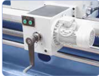
Motorisch verstellbarer Reitstock (ab Spitzenweite 3000 mm).
