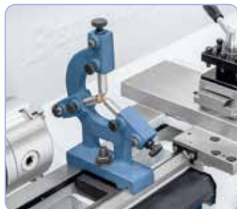
Feststehende Lünette mit Bronzeführung zum Stabilisieren von langen Werkstücken.
