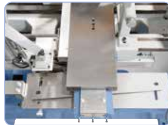
Kegeldreheinrichtung optional erhältlich, Drehlänge 455 mm, Einstellwinkel +/- 8°.
