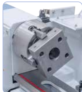
Planscheibe 100 mm (Option) zum Spannen von unregelmäßig geformten Werkstücken.
