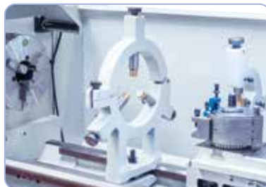
Feststehende Lünette zum Stabilisieren von langen Werkstücken
