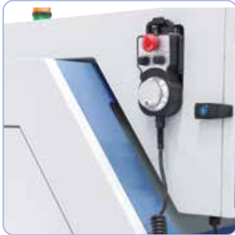
Inklusive elektronischem Handrad
