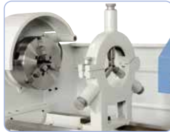
Feststehende Lünette zum Stabilisieren von langen Werkstücken
