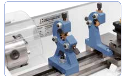
Die Lünetten erleichtern das Bearbeiten von längeren Werkstücken.
