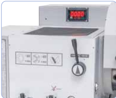
Elektronisch, stufenlose Drehzahlregelung, leichtes Ablesen mittels Digitalanzeige.
