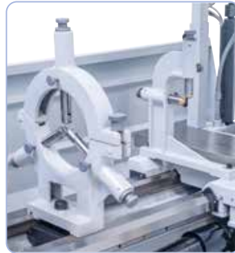
Zum Stabilisieren von langen Werkstücken serienmäßig mit einer feststehenden bzw. mitlaufenden Lünette ausgestattet.
