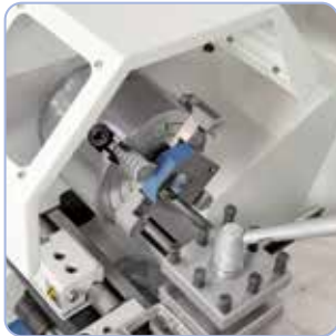
Planscheibe 160 mm (Option) ideal zum Aufspannen von asymmetrischen Werkstücken.
