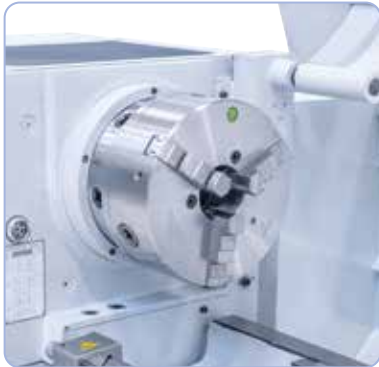
Vorteil des Bernardo-Backenfutters PS3-250 mm / D8: Monoblock-, Grund-, Umkehr- und Aufsatzbacken lieferbar.
