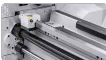
Mikrometerlängsanschlag und Rutschkupplung im Lieferumfang enthalten.
