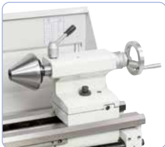
Der Reitstock mit Einhebelklemmung kann zum Kegeldrehen verstellt werden, auf Wunsch mit Zentrierkegel lieferbar
