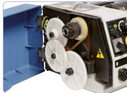
Optional mit Wechselräder zum Gewindeschneiden (Steigung von 0,5 - 1,25 mm)
