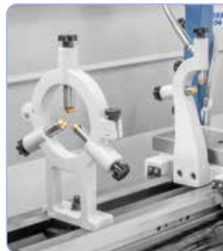
Zum Stabilisieren von langen Werkstücken serienmäßig mit einer feststehenden bzw. mitlaufenden Lünette ausgestattet.
