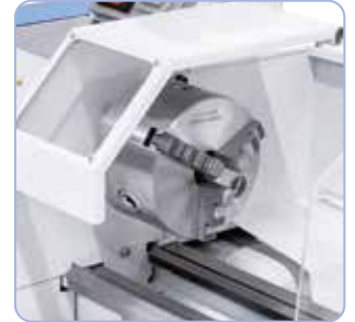
3-Backenfutter 125 mm mit Dreh- und Bohrbacken im Lieferumfang enthalten
