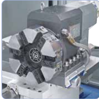
Robuster Werkzeugrevolver mit 6 Stationen.
