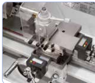
Zum rationellen Arbeiten ist die Maschine serienmäßig mit einem Schnellwechselstahlhalter ausgestattet.
