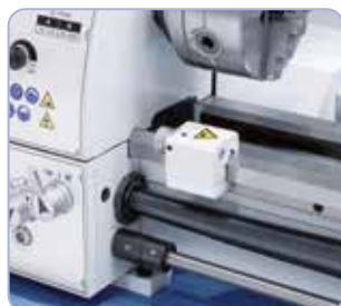
Modell 700 PRO serienmäßig mit Rutschkupplung und Mikrometerlängsanschlag ausgestattet
