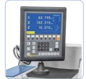
Die Maschine ist serienmäßig mit einer digitalen Positionsanzeige Bernardo ES-12 V ausgestattet.
