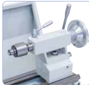
Für universellen Einsatz ist optional eine mitlaufende Körnerspitze Type SMA mit 7 auswechselbaren Einsätzen lieferbar.
