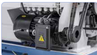
Leistungsstarker Antriebsmotor mit Magnetbremse nach CE-Norm.
