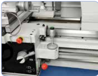
Serienmäßig mit Eilgang zur Reduzierung der Nebenzeiten
