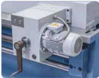
Motorisch verstellbarer Reitstock (ab Spitzenweite 3000 mm).
