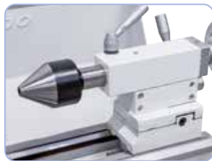
Zentrierkegel diam. 60 mm, ideal zum Spannen von Rohren und Hohlkörpern (Option)
