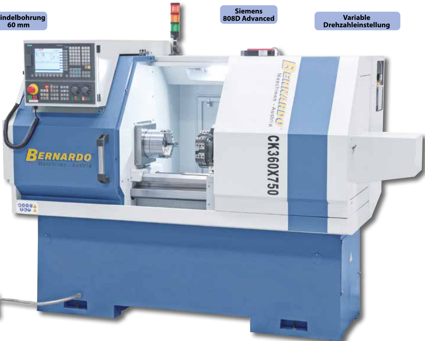
Robuster Werkzeugrevolver mit 6 Stationen.
