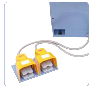
Serienmäßig mit Fußpedal zum Klemmen des Backenfutters bzw. Verfahren der Reitstockpinole.
