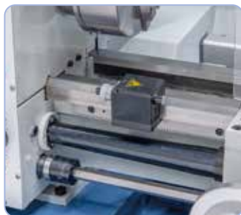
Mikrometerlängsanschlag und Rutschkupplung im Lieferumfang enthalten.
