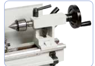
Reitstock mit MK 2 Aufnahme kann zum Kegeldrehen verstellt werden
