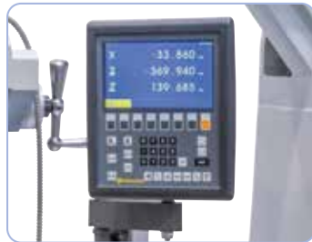
Durch die digitale Positionsanzeige wird eine Produktivitätssteigerung bis zu 50% erzielt.
