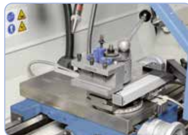
Schnellwechselstahlhalter System Multifix im Lieferumfang enthalten (Standard 165 Top)
