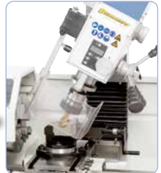
Durch den schwenkbaren Fräskopf ergeben sich eine Vielzahl von Bearbeitungsmöglichkeiten.
