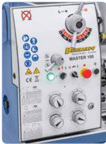
Leichtgängige Vorschub- und Drehzahlregelung am Getriebekopf, ruhiger Lauf durch gehärtete und geschliffene Zahnräder, im Ölbad laufend.
