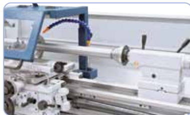
Zentrierkegel diam. 130 mm, ideal zum Spannen von Rohren und Hohlkörpern (Option).
