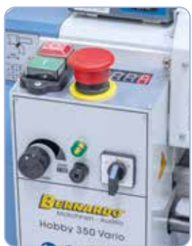
Elektronische, stufenlose Drehzahlregelung, leichtes Ablesen mittels Digitalanzeige.
