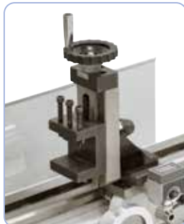
Vertikalfrässupport für zusätzliche Bearbeitungsvorgänge nachrüstbar.
