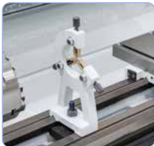
Feststehende Lünette mit Bronzeführung zum Stabilisieren von langen Werkstücken.
