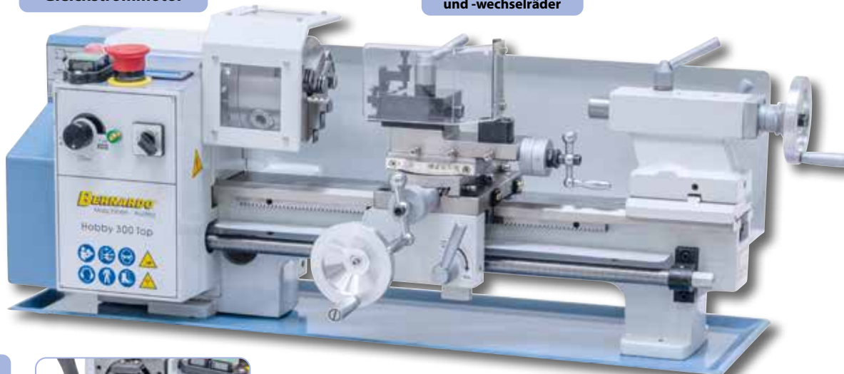
Reitstock mit MK 2 Aufnahme kann zum Kegeldrehen verstellt werden
