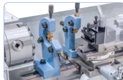
Die Lünetten erleichtern das Bearbeiten von längeren Werkstücken.
