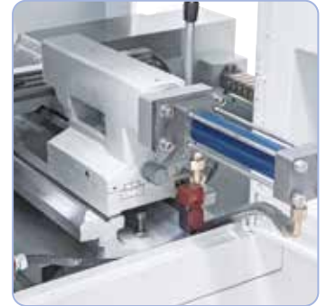
Hydraulische Verstellung der Reitstockpinole serienmäßig.
