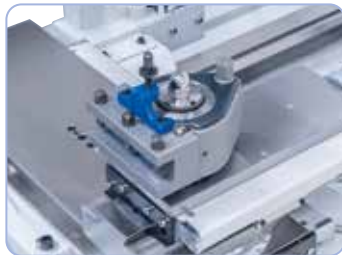
Der Schnellwechselstahlhalter ermöglicht eine Reduzierung der Nebenzeiten und gewährleistet eine hohe Wiederholgenauigkeit.
