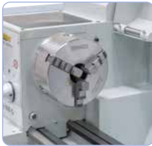
3-Backenfutter 160 mm mit Dreh- und Bohrbacken im Lieferumfang enthalten
