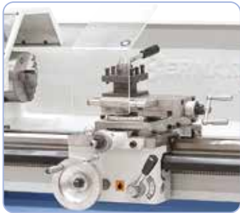
Leichtgängiger und präziser Schlitten mit Obersupport, lange Lebensdauer durch spielfrei nachstellbare Keilleisten
