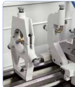
Zum Stabilisieren von langen Werkstücken serienmäßig mit einer feststehenden bzw. mitlaufenden Lünette ausgestattet.
