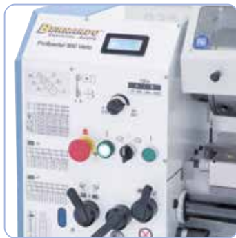
Elektronisch, stufenlose Drehzahlregelung, leichtes Ablesen mittels Digitalanzeige.
