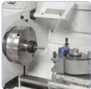
Hauptspindellager in P5-Qualität
