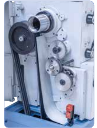
Gehärtete Hauptspindel mit Präzisionskegellager für hohe Rundlaufgenauigkeit, optimale Kraftübertragung durch verzahnte Optibelt-Keilriemen
