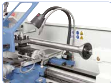
Zentrierkegel diam. 100 mm, ideal zum Spannen von Rohren und Hohlkörpern (Option)
