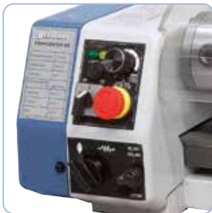
Schaltelemente (Drehzahlregelung, Wahlschalter, Vorschub, ...) am Spindelstock angebracht
