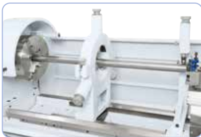
Serienmäßig mit feststehender Lünette zum Einspannen von langen Werkstücken.
