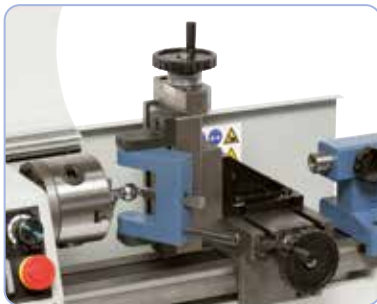
Vertikal-Frässupport mit montierter Kugeldreheinrichtung (Option)
