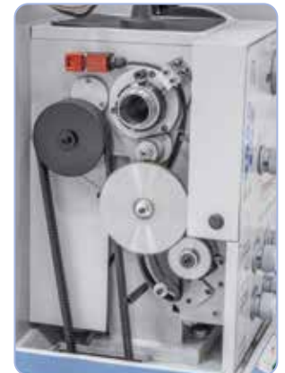
Serienmäßig ausgestattet mit Wechselrädern zum Gewindeschneiden.
